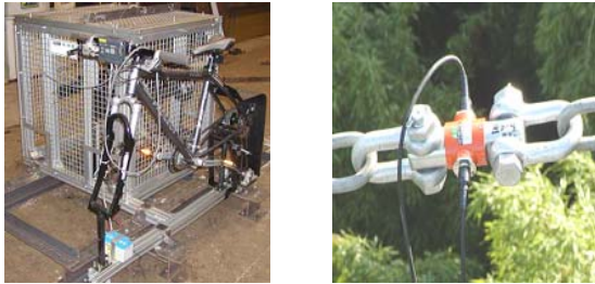
図4.1 無電源起振機「YUSURU」(左図)とロードセル(右図)
