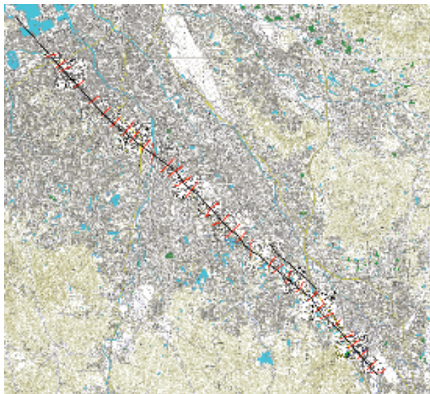
図3.2 推定断層(黒線)と今回観測した測線(赤線), 数値地図25000より作成
