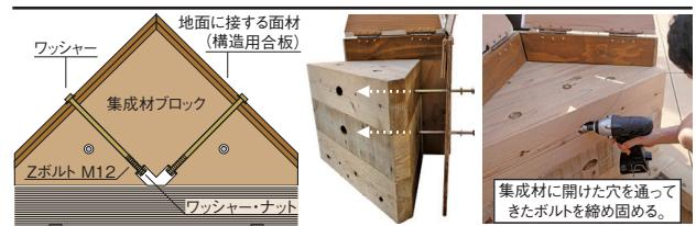
図8 基礎と上部架構の連結部
